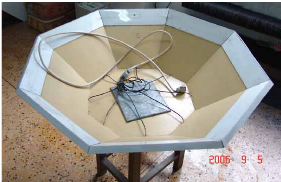
相片 3. MDCB-5-1 型临震信息监测仪的传感器（拿掉盖）：向下 45° 的 8 个壁中有 9 个传感器元件（仅可看到引线）；底部中间可见朝下的第 9 个传感器元件。
