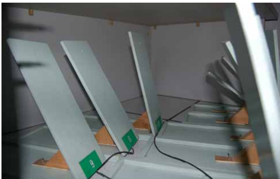
相片 5. MDCB-6 型仪的 8 个可调式传感器元件：调至对准已确定的震源区的不同部位。
